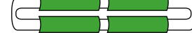
Şekil 6 / Figure 6 Sonsuz sapan için bacak başına çift parça Two pieces for each leg of round sling
