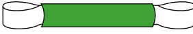
Şekil 1 / Figure 1 Gözlü sapan için tek parça Single piece for eye webbing sling
